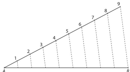
**9** Empleando el teorema de Tales, construye los  $\frac{3}{2}$  y los  $\frac{2}{5}$  del segmento  $AB$  de longitud 10 cm.
